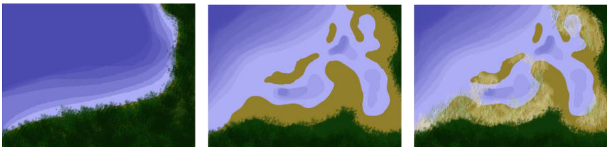
Abbildung 4: Ausgestaltung einer Uferabflachung an renaturierten Kiesabbaugewässern (l.) Ausgangssituation mit Steilufern und Gehölzbestand am Ufer (M.) Nach Maßnahmendurchführung mit Freistellen und Erdarbeiten, Modellierung mäandrierender Ufer, vorgelagerter Flachwasserzonen und Inseln (r.) Natürliche Entwicklung einer Ufervegetation mit verschiedenen Röhrichten und teils wasserständigem Schilf. Durch regelmäßige Pflege können Teilbereiche auch offen gehalten werden, um z. B. als Rastflächen zu dienen
